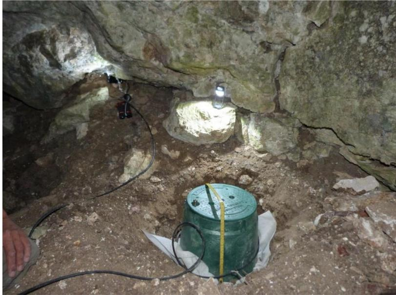
Figure 2: Installation et camouflage de l'éco-compteur
