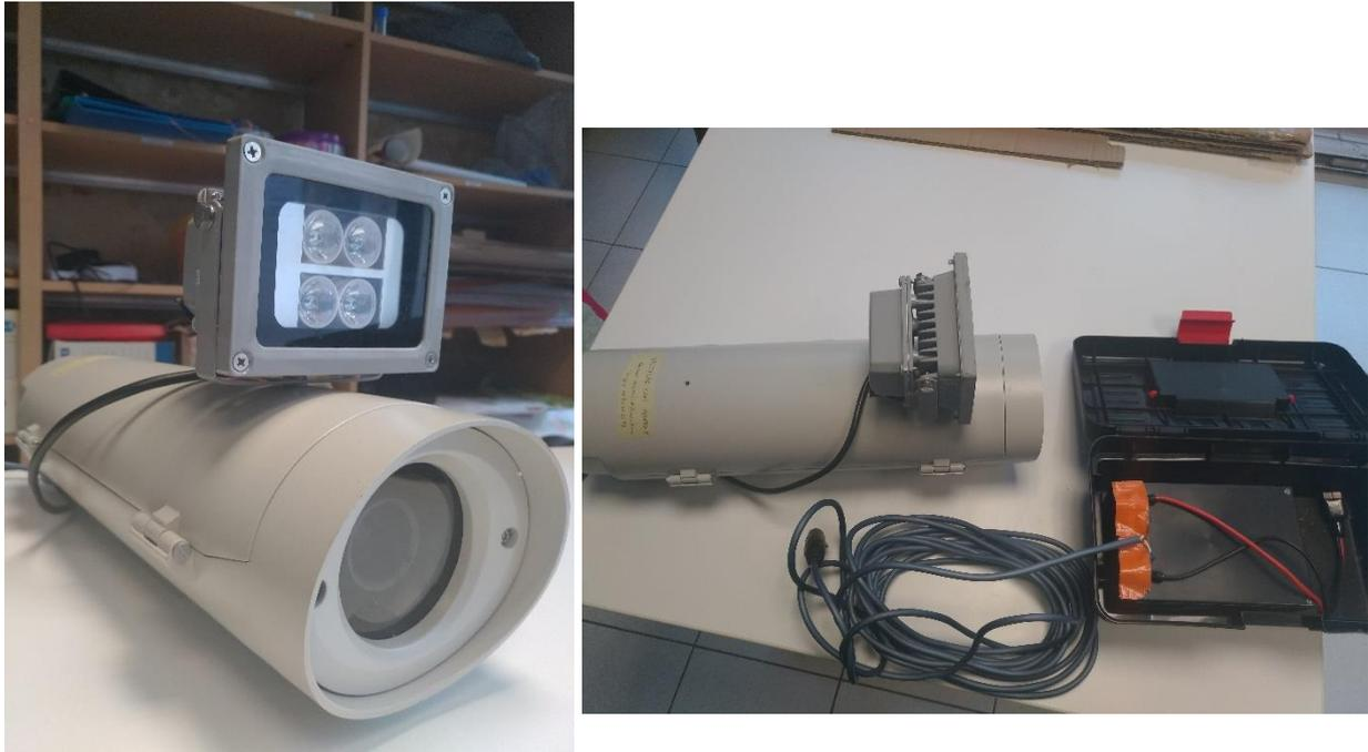
Figure 7: Vue du système optique expérimental d'imagerie nocturne
