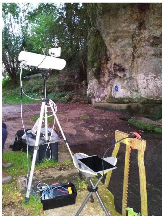
Figure 9: Matériel: caméra IR, tablette et micro US
