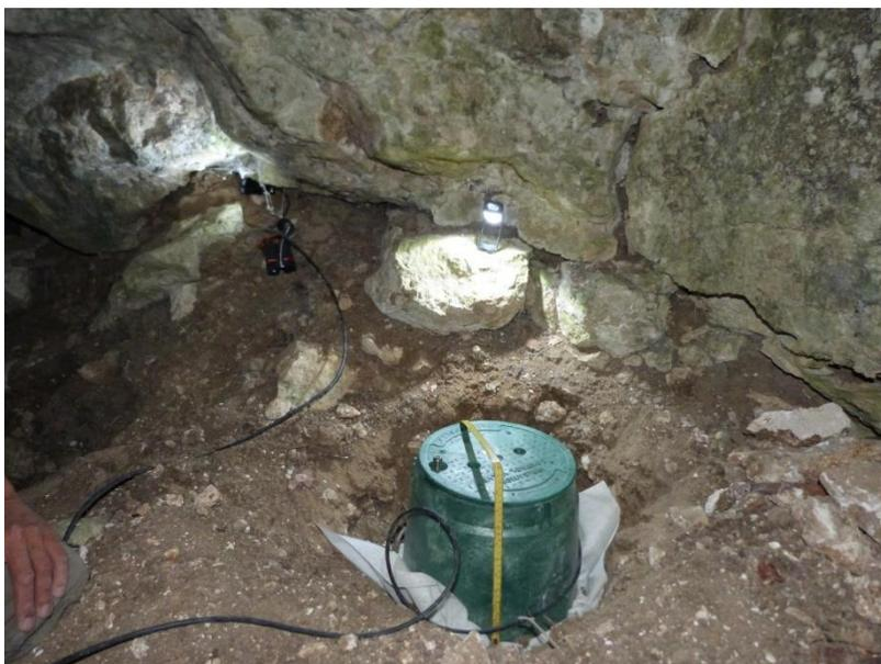
*Figure 2: Installation et camouflage de l'éco-compteur*
