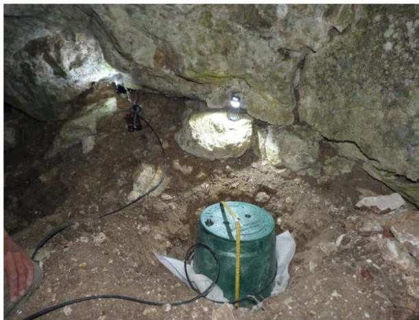
Figure 5: Installation de l'éco-compteur avant dissimulation
